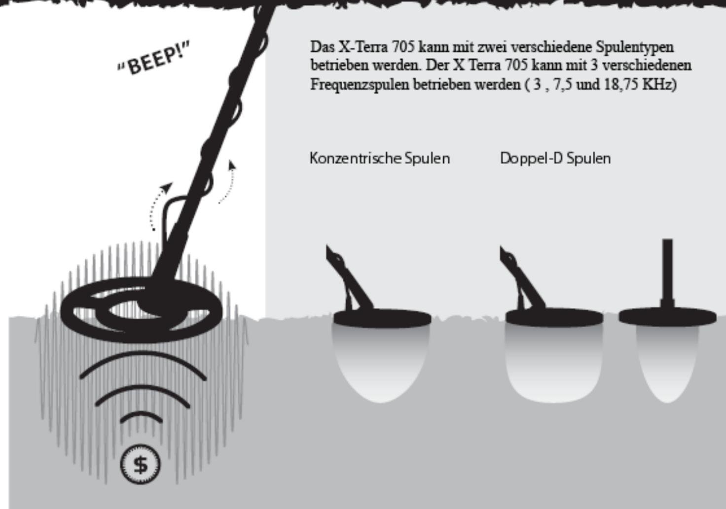
Das X-Terra 705 kann mit zwei verschiedene Spulentypen betrieben werden. Der X Terra 705 kann mit 3 verschiedenen Frequenzspulen betrieben werden ( 3 , 7,5 und 18,75 KHz)
