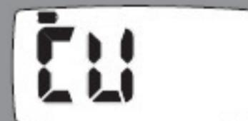
Spulenfehler: Die Spule sendet keine Signale an die Elektronik!
